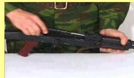
3. Присоединить затворную раму с затвором
