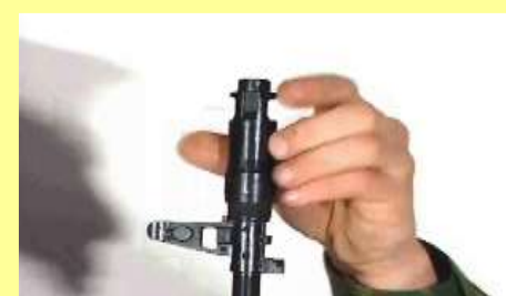
7. Присоединить дульный тормоз-компенсатор
