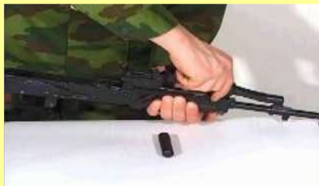
1. Присоединить газовую трубку
