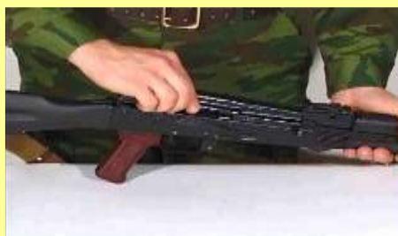
5. Присоединить крышку ствольной коробки.
